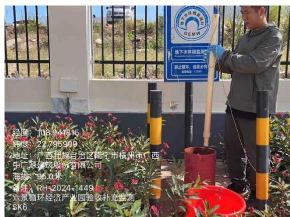
6#地下水监测井采样
