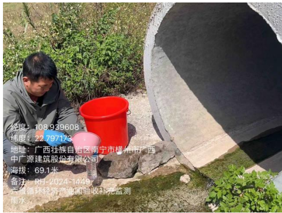
雨水排放口采样
