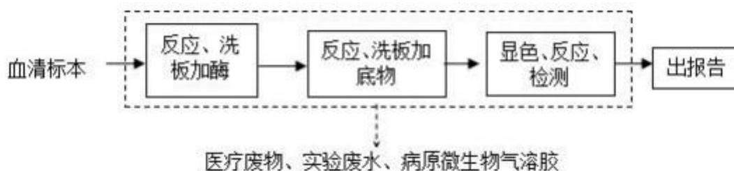
图 2-6 免疫学检验流程及产污节点图
