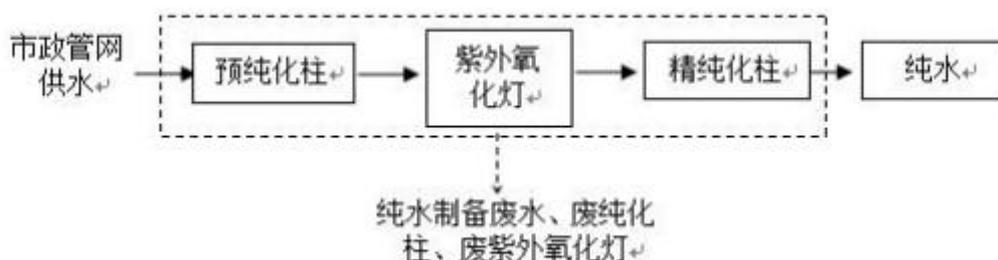
图 2-2 项目纯水制备流程及产污节点图
